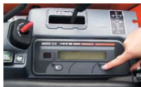
1 Introducir la llave roja de registro y pulsar el botón del panel digital.
