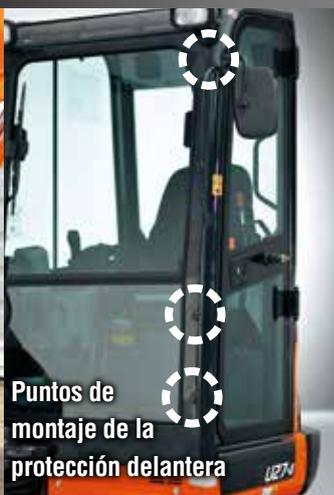
Puntos de montaje de la protección delantera
