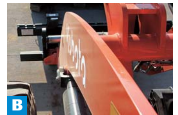
Punto de conexión del enganche rápido
